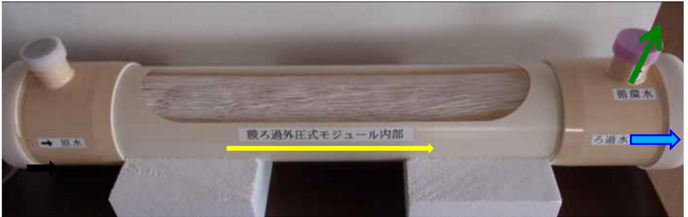
モジュールを横にしたもの。実物は処理水（原水）の入口が下側、ろ過水の出口が上側になります。
