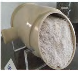
膜モジュールの断面 中空系膜が7000本!
