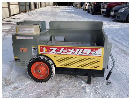
貸出機械：ハンドガイド型小型除雪機（12馬力程度）、移動式小型融雪機
